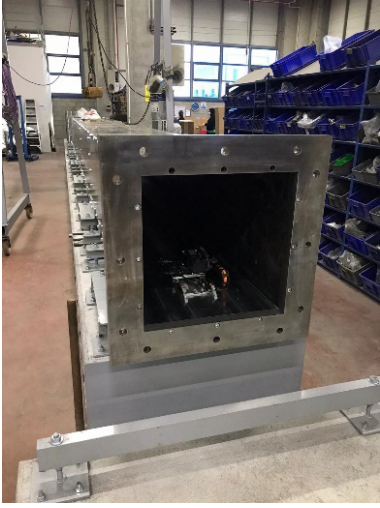
Şekil 7. Mikrofon taşıyıcı robot mekanizması
