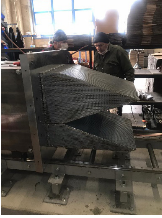
Şekil 6. Kamanın numune tutucuya montajı (solda), numune yerleştirme bölümünün tüp ile bağlantı şekli (sağda)
